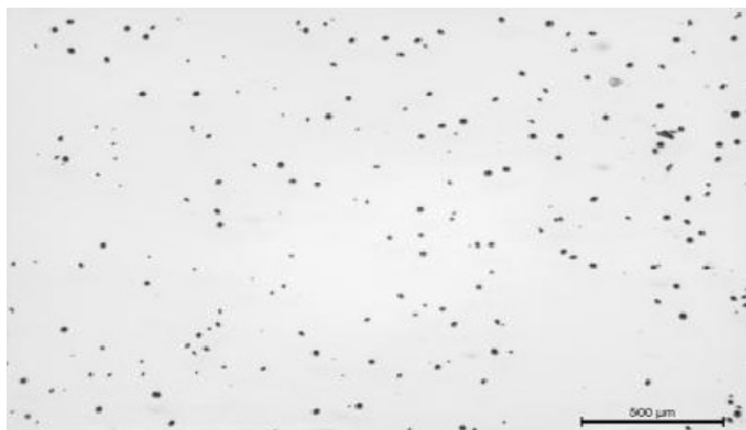
Figura 1. Imagem da superfície de um CR-39 após a revelação
